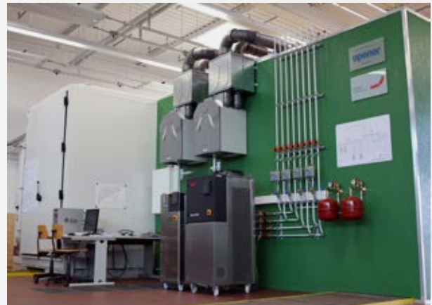
Bild 1: Ansicht des \mu KWKK-Labors (von links nach rechts: Schaltschrank mit Anbindung an das elektrische Microgrid, Blockheizkraftwerk, Wärmespeicher, reversible Adsorptions- und Kompressionskältemaschine und Kältespeicher) mit Messdatenerfassung und Klimakammer (hier mit Prozessthermostaten, rechts).
