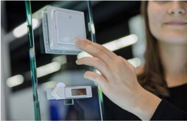
Bild 3: Energieautarke Schalter und Sensoren nutzen die Umgebung als Energiequelle. Dadurch arbeiten sie unabhängig von Kabeln oder Batterien und lassen sich auch an schwer zugänglichen Stellen platzieren. Einmal in Betrieb, müssen sie nicht gewartet werden und liefern die benötigten Rohdaten für ein digitales Flächenmanagement.
